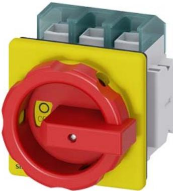
SENTRON, выключатель-разъединитель 3LD, аварийный выключатель, 3- пол., Iu: 125 A, рабочая мощность/ при AC-23A при 400 В: 45 кВт, фронтальное крепление, 1 НЗ, 1 НО, поворотный привод, цвет: красный/желтый, 4-винтовое крепление рукоятки
