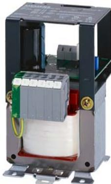
Блок питания; фазы: 1; PN (кВт): 0,06; UPRI (B): 400–230+/-15; USEC (B DC): 24; ISEC (A DC): 2,5/3 (60/40 °C); F (Гц): 50–60; группа перекл./экран. эфф.: II 0/0; кл. защиты: I; TA/кл. изол.: 60/B; W (%): 5; IP00; подключение: винтовой зажим; монтаж: винты/ DIN-рейка; EN 61558-2-6, EN 61131-2 >Изолирующий трансформатор<
