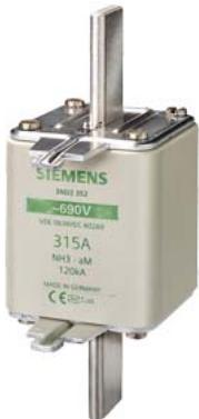
вставка предохранителя NH, NH3, In: 630 A, aM, Un AC: 690 V, фронт. индикат., токопроводящие монт. выступы
