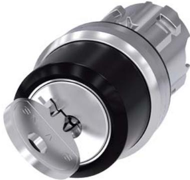
Переключатель с ключом Ronis, 22 мм, кругл., металл, глянцев., номер замка SB30, с 2 ключами, 2 положения переключателя O<|I, нажатием на кнопку, угол переключения 45°, 10:30 ч/12 ч, извлечение ключа O, возможные специальные запоры: SB31, 421, 455
