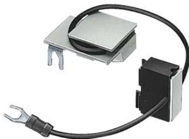
Ограничитель перенапряжения Варистор с распоркой провода 400–600 В AC для установки на вывод катушки для контакторов типоразмера S0–S2
