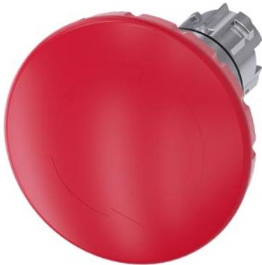
Грибовидная кнопка аварийного останова, 22 мм, кругл., металл, глянцев., цвет: красный, 60 мм, положительная блокировка, согласно DIN EN ISO 13850, поворотный расцепной механизм
