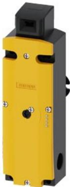
Позиционный выключатель безопасности с удерживающим устройством Усилие нажатия 1300 Н 5 направлений подвода С пружинным фиксатором Аварийная разблокировка сзади Вспомогательная деблокировка спереди Напряжение магнита 115 В AC Контроль исполнительного механизма 2 НЗ/1 НО Контроль электромагнита 2 НЗ/1 НО Светодиодная индикация, цвет: желтый/зеленый Поставка без исполнительного механизма. Исполнительный механизм 3SE5000-0AV0. заказывается отдельно
