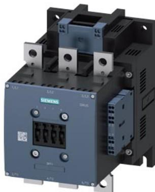
Силовой контактор, AC-3 300 A, 160 кВт/400 В AC (50–60 Гц)/режим работы по DC UC 220–240 В Вспомогательные контакты 2 НО + 2 НЗ 3-полюсн., типоразмер S10, шинные соединения Привод: стандартный пружинная клемма
