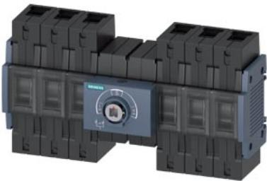
SENTRON, сетевой коммутатор 3КС, с ручным управлением, MTSE, типоразмер: 2, 3-пол., I<sub>u</sub>: 160 A, U<sub>e</sub> AC: 415 В, I<sub>e</sub> при AC-33 В, при 415 В: 160 A, I<sub>e</sub> при AC-23A при 690 В: 125 A, винтовое и реечное крепление 35 мм, фронтальный привод, средн., без рукоят., рамочная клемма
