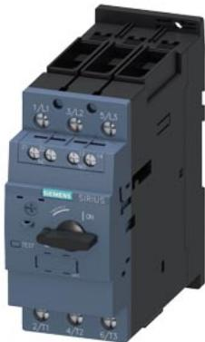
Автоматический выключатель, типоразмер S2 для защиты двигателя, класс срабатывания 10 Максимальный расцепитель тока с обратнозависимой выдержкой времени 28–36 A N-расцепитель 520 A Винтовой зажим Стандартная коммутационная способность с попечным выключателем вспомогательных цепей 1 НО + 1 НЗ
