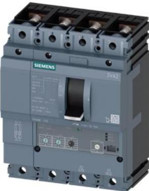
авт. выключатель 3VA2 IEC типоразмер 100 класс коммутационной способности M  $I_{cu} = 55 \text{ kA}$  @ 415 В 4-пол., защита оборудования ETU320,  $I_L, I_n = 100 \text{ A}$  защита от перегрузки  $I_r = 40 \dots 100 \text{ A}$  защита от коротких замыканий  $I_t = 1,5 \dots 12 \times I_n$  защита нейтрали регулируемая (ВЫКЛ., 50%, 100%) плоский винтовой зажим
