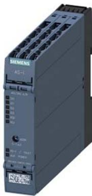
Модуль AS-i SlimLine Compact SC22.5, цифровой, A/B-подчиненный компонент 4 ЦВх/2 РелВых, IP20 4 x вход для 3-проводного датчика Питание датчика с возможностью переключения 2 x релейный выход 1 А 24 В DC винтовые клеммы Установочная ширина 22,5 мм
