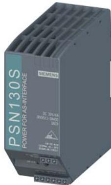
PSN130S 4A 120 В/230 В AC IP20 Блок питания 30 В, для AS-i без разъединения данных AS-i Вход: 120 В/230 В AC Выход: 30 В DC, 4 A, IP20 со встроенным распознаванием перегрузки с сигнальным контактом
