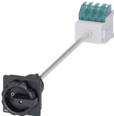
SENTRON, выключатель-разъединитель 3LD, главный выключатель, 4-пол., Iu: 16 A, рабочая мощность/ при AC-23A, при 400 В: 7,5 кВт, монтаж на горизонтальную поверхность, в т. ч. дверная муфта, поворотный привод, цвет: черный, 4-винтовое крепление рукоятки
