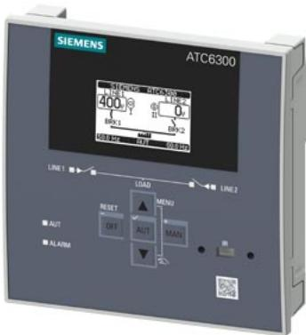
SENTRON 3KC ATC6300; ЖКД; 144x144 мм; автомат ввода резерва для управления авт. выключателями в литом корпусе, авт. выключателями, выключателями-разъединителями; для переключения нагрузки между основной и запасной сетью; устройство для установки в распр. щиты; Un 100...240 В AC, 50/60 Гц, 110...250 В DC; Un 12...24 В DC ном. напряжение Ue: 100...480 В AC, 50/60 Гц; винтовой клеммный зажим возможность расширения макс. 2 дополнительными модулями
