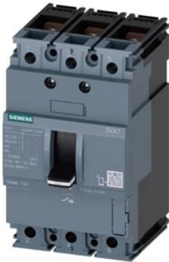
авт. выключатель 3VA1 IEC типоразм. 100 класс коммутационной способности N Icu = 25 kA @ 415 В 3-пол., защита оборудования TM210, FTFM, In = 32 A защита от перегрузки фикс. значение Ir = 32 A защита от коротких замыканий li = 10 x In плоский винтовой зажим
