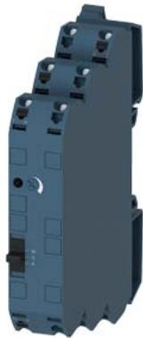
Разделительный преобразователь с выключателем Н-А 24 В AC/DC, 3-канальное разделение Вход: 0–10 В, 0/4–20 мА Выход: 0–10 В, 0/4–20 мА Пружинная клемма (Push-In)
