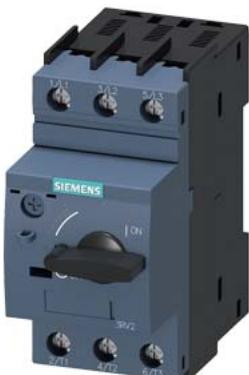
Специальный тип Автоматический выключатель, типоразмер S00 для защиты трансформатора Максимальный расцепитель тока с обратнозависимой выдержкой времени 10–16 A N-расцепитель 286 A Винтовой зажим Стандартная коммутационная способность Температура окружающего воздуха –50 °C 500 рабочих циклов
