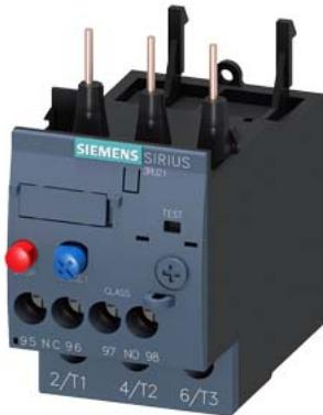
Реле перегрузки 11–16 А теплов. для защиты двигателя типоразмер S0, класс 10 Для установки на контакторах Главная цепь: винт Вспомогательная цепь: винт Ручной/автоматический сброс
