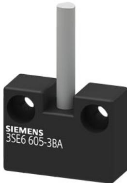
Выключатель с магнитным приводом Контактный блок, прямоугольный малый 25 x 33 мм Контактные элементы 1 НЗ/1 НО с кабелем 3 м
