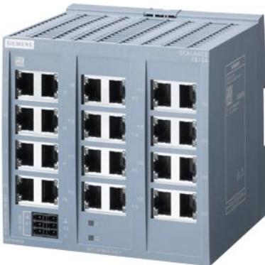
SCALANCE XB124 промышленный неуправляемый коммутатор Industrial Ethernet, 24x электрических RJ45 порта 10/100 Мбит/с; для создания небольших сетей с топологией звезда или шина; светодиодная индикация, IP20, резервированное питание 24 В AC/DC, электронное руководство доступно для загрузки.
