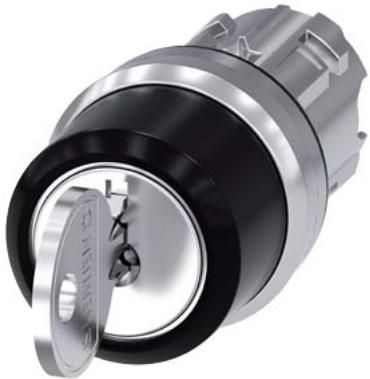
Переключатель с ключом Ronis, 22 мм, кругл., металл, глянцев., номер замка SB30, с 2 ключами, 3 положения переключателя O-I-II, с фиксацией, угол переключения 2 x 45°, 10:30 ч/12 ч/13:30 ч, извлечение ключа O+II, возможные специальные запоры: SB31, 421, 455
