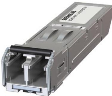
SCALANCE X SFP991-1 SFP-модуль, вставляемый модуль приемопередатчика, с конформным покрытием, 1x оптический LC-порт (многомод) 100 Мбит/с, для линий передачи до 5 км.
