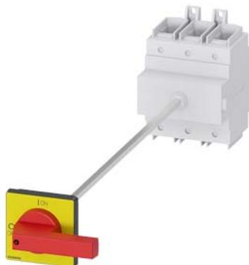
SENTRON, выключатель-разъединитель 3LD, аварийный выключатель, 3- пол., I<sub>u</sub> = 250 A, рабочая мощность/ при AC-23A при 400 В: 132 кВт, монтаж на горизонтальную поверхность, в т. ч. дверная муфта, привод с поворотной рукояткой, цвет: красный/желтый, 4-винтовое крепление рукоятки
