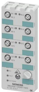
Компактный модуль AS-i K60, цифровой А/В-подчиненный компонент, 4 ЦВх/4 ЦВх, IP67 4 x вход, макс. 1000 мА Питание датчика от 24 В DC 4 x выход, 2 A, 24 В DC макс. 4 A на все выходы Гнездовой контакт 8 x M12 с Y-II-распределением Монтажная панель 3RK1901-0CA00 заказывается отдельно
