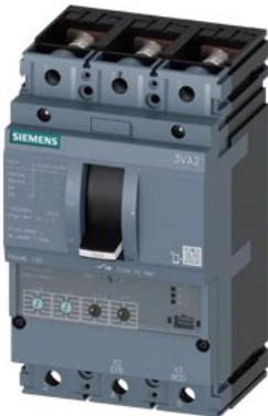
авт. выключатель 3VA2 IEC типоразмер 160 класс коммутационной способности M  $I_{cu} = 55 \text{ kA}$  @ 415 В 3-пол., защита оборудования ETU350, LSI,  $I_n = 160 \text{ A}$  защита от перегрузки  $I_r = 63 \dots 160 \text{ A}$  защита от коротких замыканий  $I_{sd} = 1,5 \dots 10 \times I_r$ ,  $I_i = 10 \times I_n$  плоский винтовой зажим
