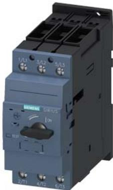
Автоматический выключатель, типоразмер S2 для защиты двигателя, класс срабатывания 10 Максимальный расцепитель тока с обратнозависимой выдержкой времени 14–20 A N-расцепитель 260 A Винтовой зажим Стандартная коммутационная способность
