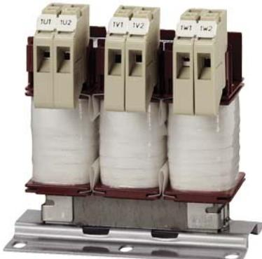
Сетевой дроссель для преобр. част.; фазы: 3; UN1 (B): 480; Ithмакс. 1 (A)/ F1(Гц): 6,3/60; I LN (A): 5,67; UK (%): 2; LN(MH): 2,24; TA/кл. изол.: 40/B; IP00; подключение: винтовое/с плоским вставным штекером; зажим; EN 61558-2-20 >Признано UL/CSA< >Дроссель<
