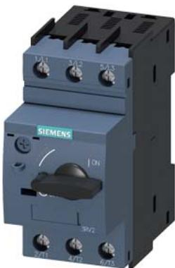
Автоматический выключатель, типоразмер S00 для защиты двигателя, класс срабатывания 10 Максимальный расцепитель тока с обратнозависимой выдержкой времени 9–12,5 A N-расцепитель 163 A Винтовой зажим Стандартная коммутационная способность
