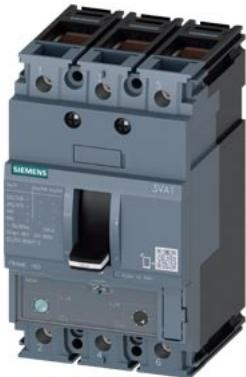
авт. выключатель 3VA1 IEC типоразм. 160 класс коммутационной способности H  $I_{cu} = 70 \text{ kA}$  @ 415 В 3-пол., защита оборудования TM240, ATAM,  $I_n = 160 \text{ A}$  защита от перегрузки  $I_r = 112\ldots 160 \text{ A}$  защита от коротких замыканий  $I_i = 5\ldots 10 \times I_n$  клеммное соединение
