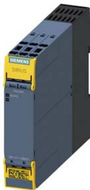
Предохранительное устройство SIRIUS Расширение выхода 4RO с разблокирующими цепями реле 4 замыкающих контакта плюс сигнальная цепь реле, 1 размыкающий контакт  $U_s = 110\text{--}240$  В AC/DC Пружинная клемма (Push-In)
