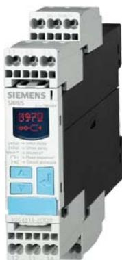
Цифровое реле контроля для 3-фазного напряжения с нейтральным проводом Подключаемое чередование фаз Выпадение фазы 3 х 90–400 В AC, 50–60 Гц Пониженное напряжение и перенапряжение 90–400 В Гистерезис 1–20 В по 0–20 с для Umin и Umax 1 Вт для Umin 1 Вт для Umax Пружинная клемма
