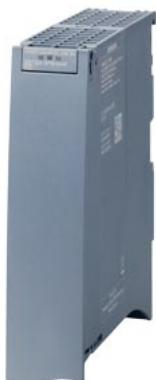
SIMATIC S7-1500, модуль дискретных входов/выходов, DI 32x24VDC BA SNK / SRC, 32 канала в группах по 16, входная задержка типично 3,2 мс, вход типа 3 (IEC 61131), вход sinking/sourcing, DQ 32XDC 24V/0.3A SNK BA; 32 канала в группах по 16; 2 A на группу при 60 °C; выход sourcing (PNP); модуль шириной 35 мм; кабели и клеммные блоки заказываются отдельно, как принадлежности
