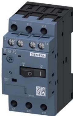
Силовой выключатель, типоразмер S00 для защиты двигателя, класс 10 Максимальный расцепитель тока с обратнозависимой выдержкой времени 1,4–2 A N-расцепитель 26 A винтовой зажим Стандартная коммутационная способность с поперечным выключателем вспомогательных цепей 1 NO + 1 NC
