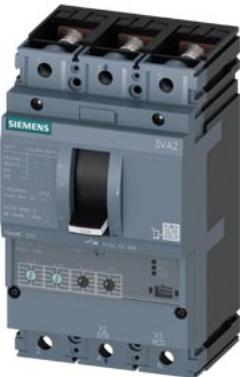
авт. выключатель 3VA2 IEC типоразм. 250 класс коммутационной способности H  $I_{cu} = 85 \text{ kA}$  @ 415 В 3-пол., защита оборудования ETU350, LSI,  $In = 160 \text{ A}$  защита от перегрузки  $I_r = 63 \dots 160 \text{ A}$  защита от коротких замыканий  $I_{sd} = 1,5 \dots 10 \times I_r$ ,  $I_i = 12 \times In$  плоский винтовой зажим
