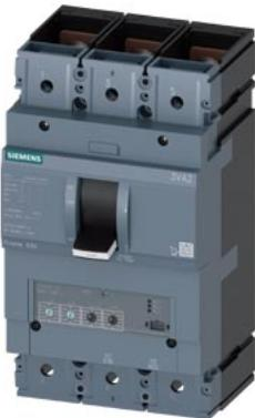
авт. выключатель 3VA2 IEC типоразм. 630 класс коммутационной способности M  $I_{cu} = 55 \text{ kA}$  @ 415 В 3-пол., защита оборудования ETU350, LSI,  $I_n = 630 \text{ A}$  защита от перегрузки  $I_r = 250 \dots 630 \text{ A}$  защита от коротких замыканий  $I_{sd} = 1,5 \dots 9 \times I_r$ ,  $I_i = 9 \times I_n$  плоский винтовой зажим
