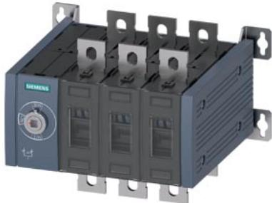
SENTRON, сетевой коммутатор 3КС, с ручным управлением, MTSE, типоразмер: 3, 3-пол., I<sub>u</sub>: 315 A, U<sub>e</sub> AC: 415 В, I<sub>e</sub> при AC-33 В, при 415 В: 315 A, I<sub>e</sub> при AC-23A при 690 В: 315 A, винтовое крепление, фронтальный привод, левосторонний, без рукоятки, шинное соединение
