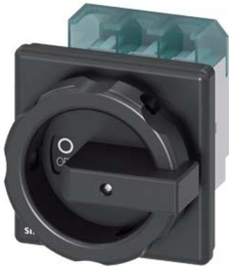
SENTRON, выключатель-разъединитель 3LD, главный выключатель, 3-пол., Iu: 63 A, рабочая мощность/ при AC-23A при 400 В: 22 кВт, фронтальное крепление, поворотный привод, цвет: черный, 4-винтовое крепление рукоятки
