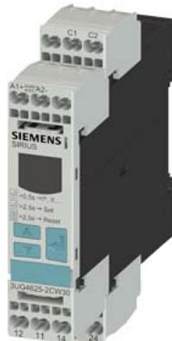
ЭЛЕКТРОННОЕ РЕЛЕ КОНТРОЛЯ ТОКА ТОКА УТЕЧКИ (С ТРАНСФОРМАТОРОМ ТОКА 3UL23), ДИАПАЗОН УСТАВОК: 0.03А ... 40А, РАЗДЕЛЬНЫЙ СИГНАЛ ПРЕДУПРЕЖДЕНИЯ И СРАБАТЫВАНИЯ, НОМ. РАБ. НАПРЯЖЕНИЕ УПРАВЛЕНИЯ US AC/DC 24 ... 240 В (ДЛЯ АС - 50 ... 60 ГЦ), ЗАДЕРЖКА СТАРТА И СРАБАТЫВАНИЯ: 0.1 ... 20 СЕК., ГИСТЕРЕЗИС ОТКЛ.: 50%, ГИСТЕРЕЗИС ПРЕДУПРЕЖДЕНИЯ: 5%, ШИРИНА 22.5 ММ, 2 П КОНТАКТА, С-ИЛИ БЕЗ ЛОГА ОШИБОК, ПРУЖИННЫЕ КЛЕММЫ
