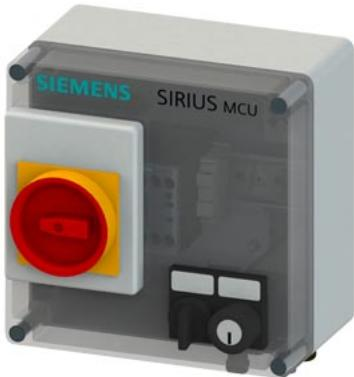
Пускатель электродвигателя SIRIUS MCU Степень защиты корпуса IP55, пластмасса Коммуникация, отсутствует электромеханическое переключение Защита от коротких замыканий с автоматическим выключателем Реверсивный пускатель Тормоз, отсутствует Класс мощности 4 А Силовой защитный выключатель двигателя биметаллич., термич. Ручное управление, с фиксацией Силовое подключение, резьбовое M-соединение Исполнение EGH
