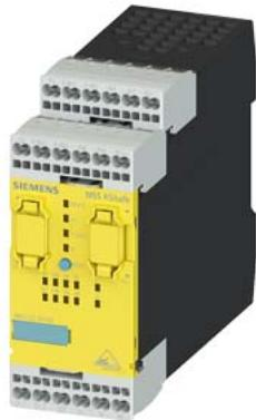
SIRIUS, Центральный модуль 3RK3 ASIsafe Extended для модульной системы безопасности 3RK3 2/4 Оу-ЦВх, 4 ЦВх, 1 Оу-РелВых, 1 Оу-ЦВых, 24 В DC Мониторы ведомых устройств ASI Активация 10 безопасных выходов на разъеме шины AS-интерфейса возможность параметрирования с помощью программного обеспечения Safety ES Установочная ширина 45 мм Пружинная клемма до SIL3 (МЭК 61508) до уровня производительности Е (ISO 13849-1) 2 блока расширения с возможностью подключения
