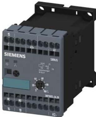
Реле времени, электронн. с выдержкой времени при срабатывании 1 переключающий контакт 24 В AC/DC, 200–127 В AC AC, 50/60 Гц 0,05 с – 100 ч Установочная ширина 45 мм Пружинная клемма
