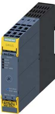
Реверсивный пускатель Failsafe, 3RM1, 500 В, 0,55–3 кВт, 1,6–7 А, 110–230 В AC, винтовой зажим/подключение на пружинных клеммах
