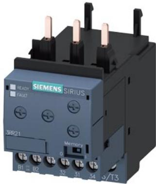
Реле контроля, установка на контактор 3RT2, типоразмер S0 Basic, аналоговая регулировка Мониторинг кажущегося тока 4–40 А, 50–60 Гц, 2-фазн. Питание 24–240 В AC/DC 1 переключающий контакт Контроль на Превышение и недостижение Выпадение фазы Обрыв провода контроль рампы торможения (с или без датчика) Задержка пуска 0–60 с Отфильтровывание импульсных помех 0–30 с Гистерезис срабатывания 6 % Соединение с помощью винтовых зажимов
