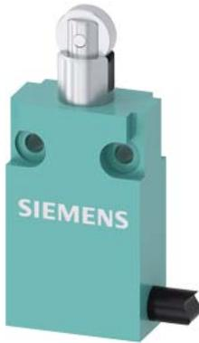
Позиционный выключатель с компактной конструкцией шириной 30 мм с соединительным кабелем 5 м Контакты мгновенного действия 1 НО + 1 НЗ с роликовым толкателем
