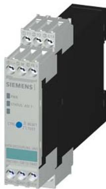
AS-i, разъединитель данных 1 x 4 A Винтовые клеммы, AS-i, одинарный Развязывающий модуль данных IP20, SlimLine S22,5 винтовые клеммы Установочная ширина модуля 22,5 мм IN: 24 В/30 В DC OUT: 1 x AS-I, 4 A встроенная защита от перегрузки встроенное обнаружение замыкания на землю Сигнальный контакт Дистанционный сброс
