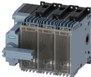
выключатель-разъединитель с предохранителем, 80А, типоразм. 1, 3-пол. для предохранителей NH разм. 000 фронтальный привод, левый комплектное устройство с прямым приводом серого цвета рамочная клемма
