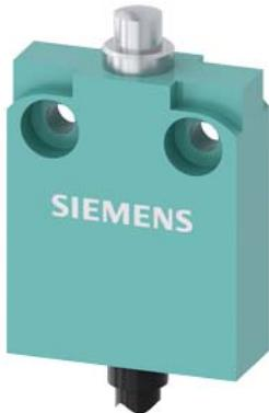
Позиционный выключатель с компактной конструкцией шириной 40 мм с соединительным кабелем 2 м Контакты мгновенного действия 1 НО + 1 НЗ Закругленный плунжер
