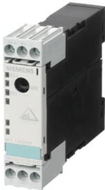
Счетный модуль, AS-интерфейс S22,5, 1 ЦВх, счетчик, IP20 1 x 1 вход счетчика, 90 mA, PNP Соединение винтовыми зажимами Установочная ширина 22,5 мм
