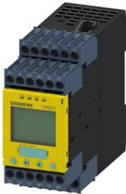
Предохранительное устройство SIRIUS безопасно-ориентир. Устройство контроля скорости вращения 110–240 В AC/DC, 45 мм Винтовой зажим FK без задержки: 2 HO FK с задержкой: 0 МК: 2 электр. Автозапуск/ручной запуск Главное устройство макс. доступн. PL согласно EN 13849-1: e макс. доступн. SIL согласно МЭК 61508: 3
